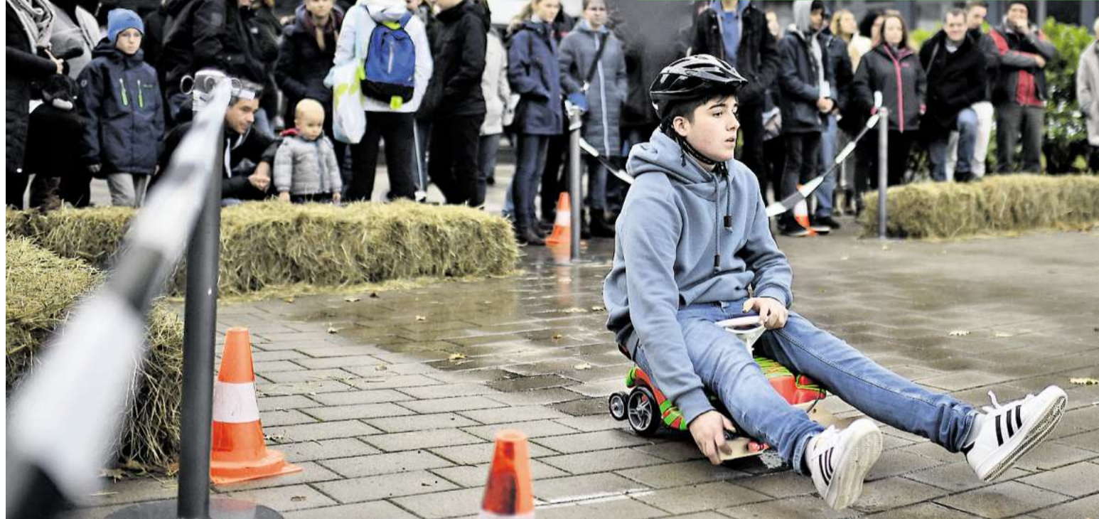
UNTERWEGS MIT HILFSMOTOR: Dieses Bobby-Car wird an der Hinterachse durch den Akkuschrauber über ein Treibrad vorwärtsgetrieben, der „Gaszug“ läuft nach vorn an die angebrachte Holztafel, die rechte Hand bedient den Schalter. Foto: Körner
